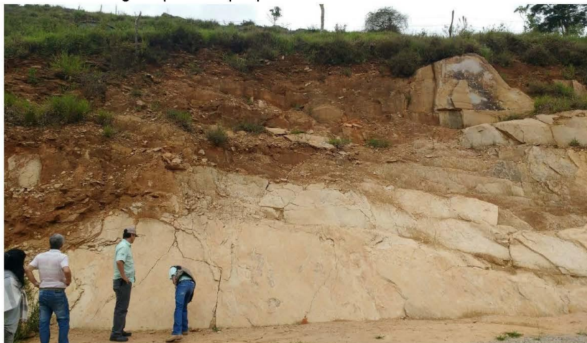
Figura 51 – Afloramento de Quartzito; maciço fraturado – Santa Rita do Ibitipoca. Foto: Felipe Oliveira.
