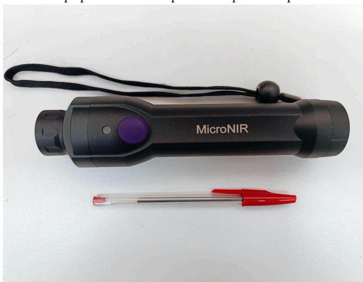
Figura 1 – Detalhe do equipamento de espectroscopia NIR portátil utilizado no estudo.
