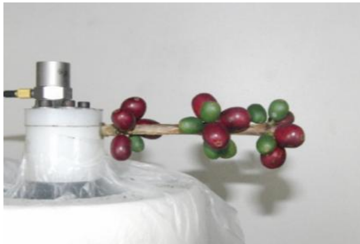
Figura 23: Engaste do ramo de café na base móvel da máquina vibradora.
