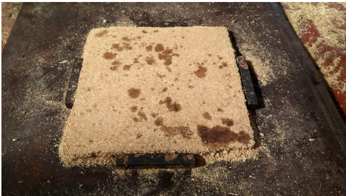
Figura 4 - Painel aglomerado produzido com resíduos agrícolas de feijão e madeira de pinus.
