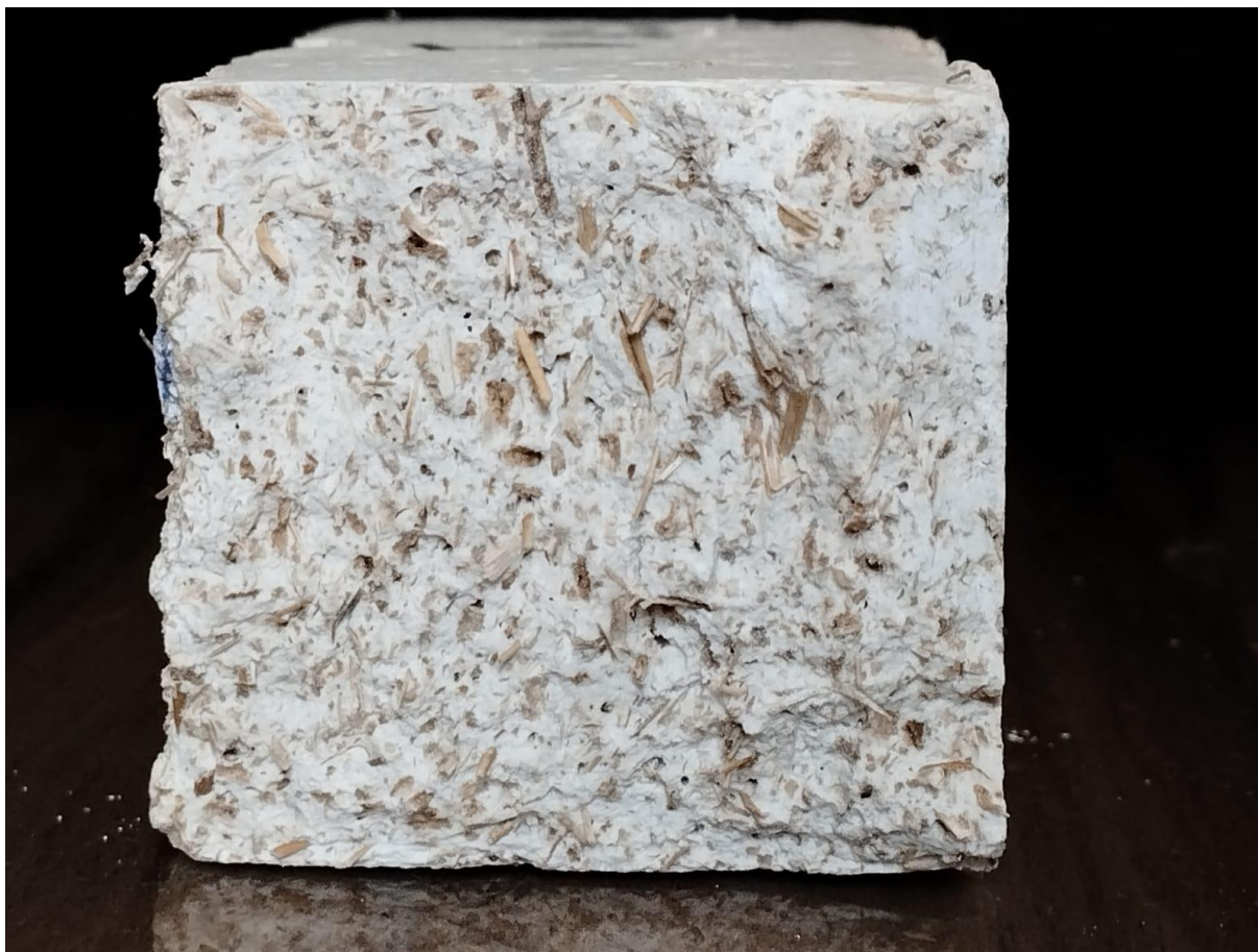
Figura 5 - Compósito de gesso reforçado com partículas de resíduos de feijão.
