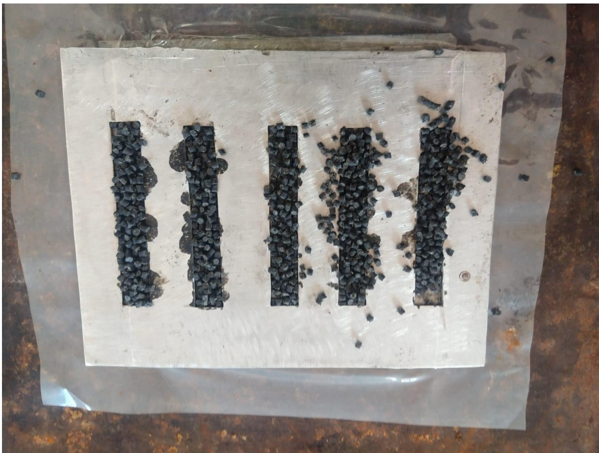
Figura 6 - Pellets de PEBD e resíduos de feijão para produção de madeira polimérica.
