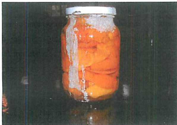
FIGURA 2 Conserva de pequi em salmoura 15% de cloreto de sódio, apresentando alteração na embalagem: corrosão externa da tampa e extravasamento de líquido.
