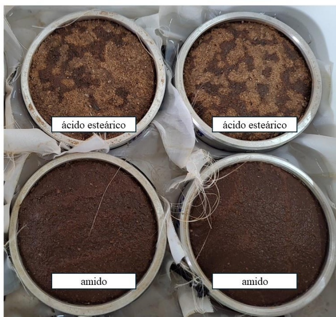
Figura 5: Representação das amostras úmidas de Tecno solo tratadas com os compostos orgânicos (hidrofóbico e hidrofílico) submetidas a 78 ciclos de US.
