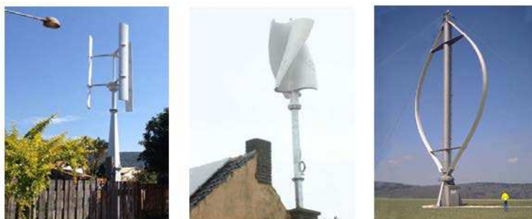
Figura 9 – Exemplos de modelos mais apropriados em áreas urbanas que usam menos espaço e geram menos ruído sonoro.
