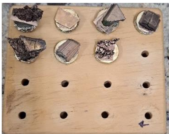
Figura 4- Amostras após metalização por pulverização catódica com ouro.
