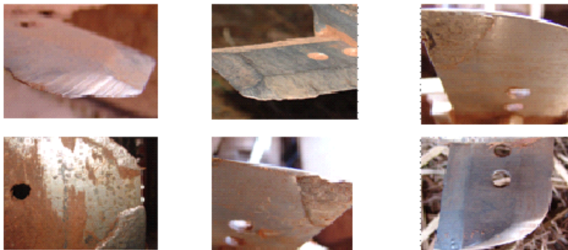
Figura 5.15 – Fotos de facas de corte basal desgastadas.
