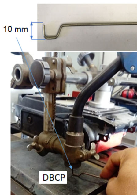
Figura 6.10 – Gabarito de controle de distância bico de contato peça (DBCP).
