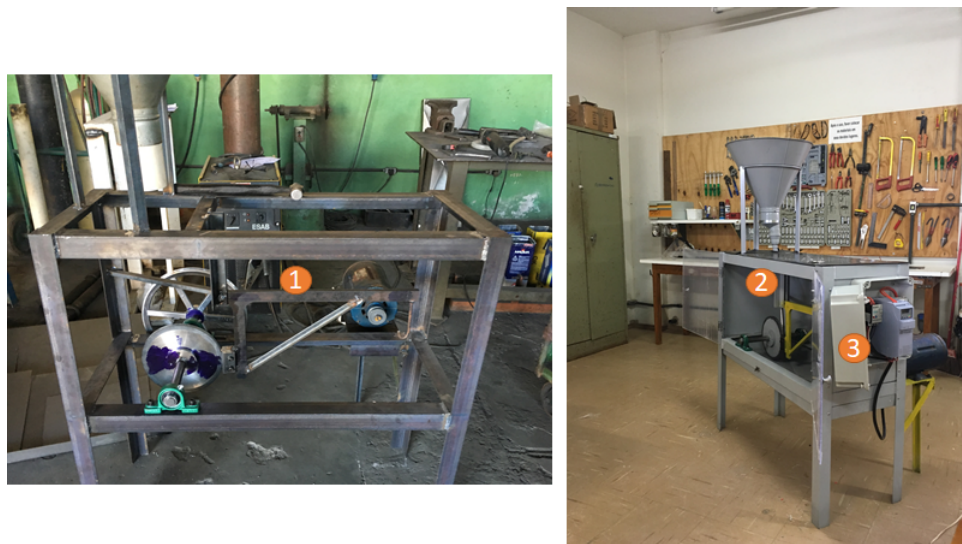
Figura 6.23 – Máquina de ensaio de abrasão de roda de borracha com areia seca: (1) Equipamento em construção; (2) Equipamento finalizado; (3) Parte de acionamento com inversor de frequência.
