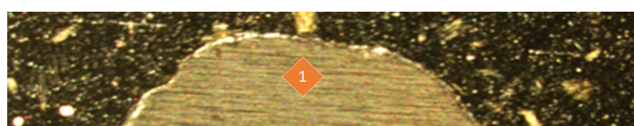
Figura 6.21 – Esquema das regiões de endentação do ensaio de micro dureza a mostra com revestimento de revestimento duro sem a adição de Cr. Onde: (1) Endentação da amostra na região próximo a superfície do revestimento duro, (2) Endentação da amostra na região de transição entre o revestimento duro e a zona fundida no centro do revestimento duro; (3) Endentação da amostra na região na região de transição entre o revestimento duro e a zona fundida na extremidade esquerda do revestimento duro; (4) Endentação da amostra na região de transição.
