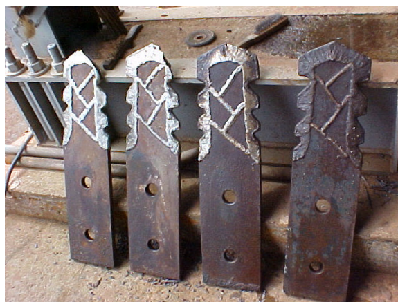
Figura 5.17 – Facas desfibradoras desgastadas e recuperadas com o processo de deposição de metal duro com o processo de soldagem FCAW.
