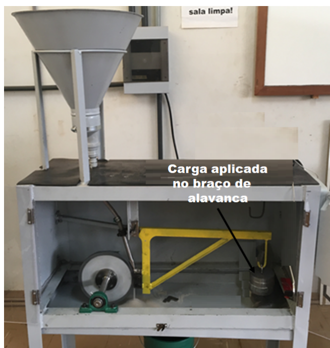
Figura 7.14 – Foto da máquina de ensaio de abrasão com roda de borracha e areia seca, conforme norma ASTM G65-16 (ASTM, 2016), instalada no Laboratório de Automação na UFLA.
