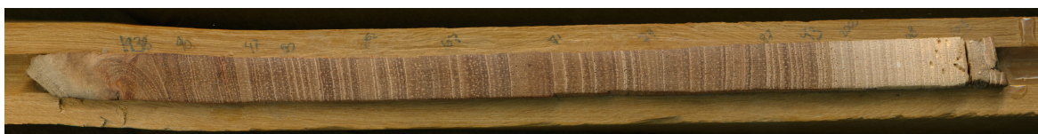
Figura 3.3 – Amostra de cedro ( Cedrela fissilis ) preparada para a medição com o LINTAB 6 Scientific
