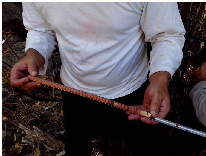
Figura 2.3 – Amostra cilíndrica retirada de cedro ( Cedrela fissilis ) nativo com o uso do Trado de Pressler
