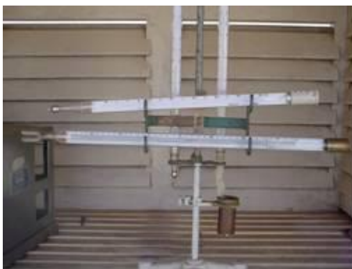
Termômetro de máxima (superior) e termômetro de mínima (inferior)
