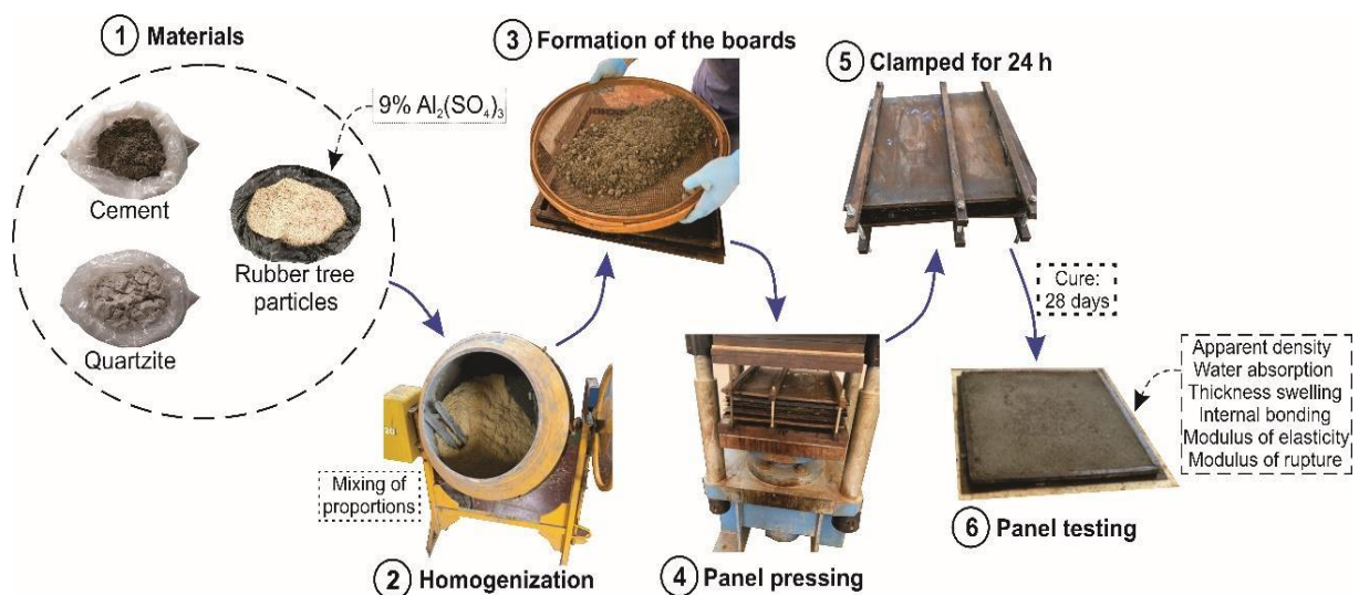
Fig. 1 Fluxograma das etapas de produção dos painéis cimento-madeira
