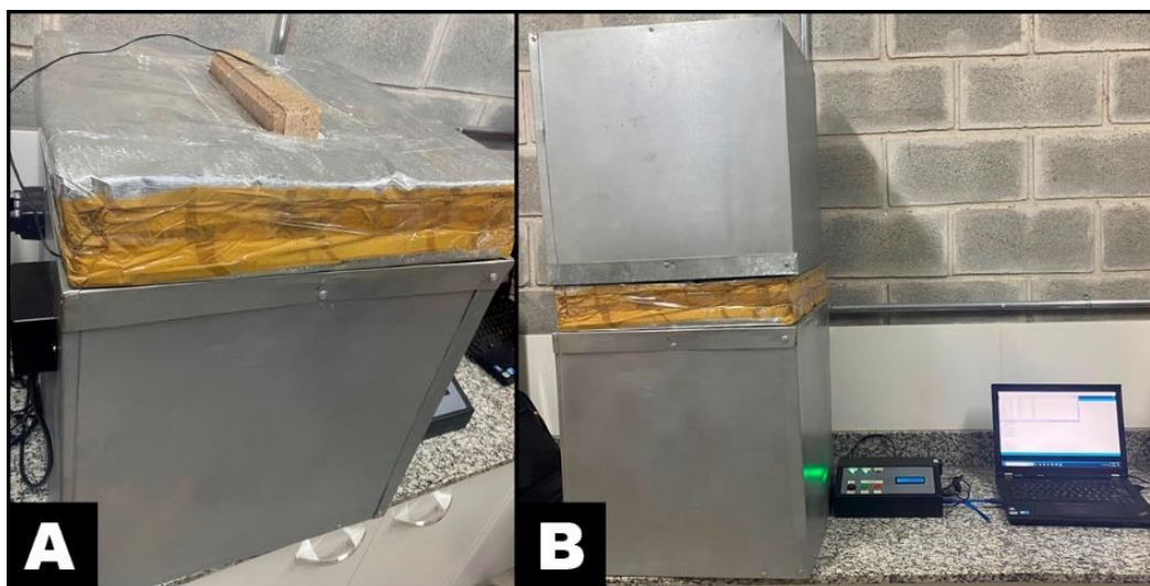
Figura 15 - Ensaio de isolamento térmico; corpo de prova posicionado na placa de isopor, com os sensores de calor fixados (A); equipamento fechado e em funcionamento (B).
