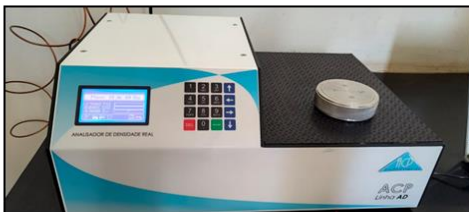
Figura 07 - Picnômetro a gás.
