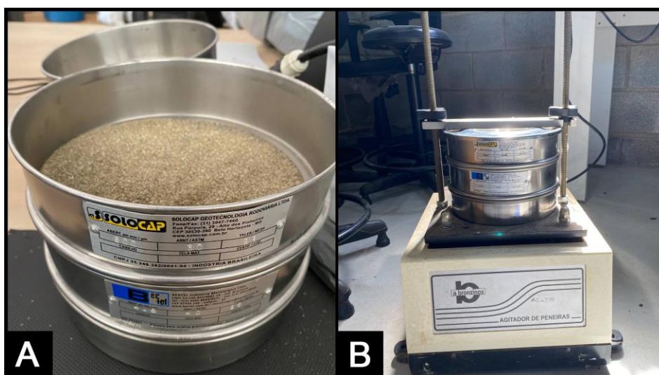
Figura 01 - Peneiramento do concentrado de Vermiculita natural: peneiras utilizadas, com o concentrado de Vermiculita (A); peneiras acopladas ao vibrador automatizado (B).
