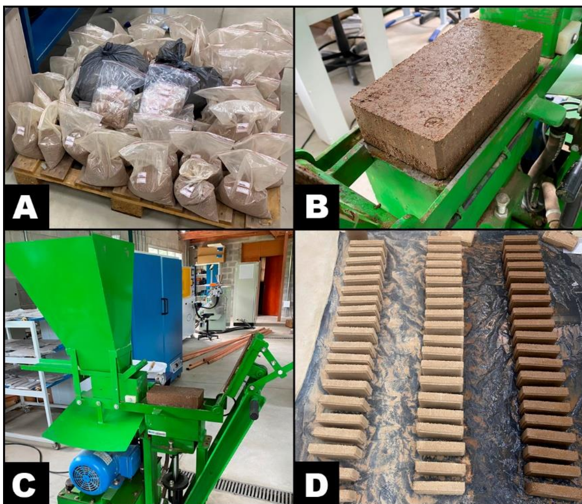
Figura 12 - Produção dos tijolos maciços de solo-cimento: materiais separados e ensacados (A); tijolo produzido (B e C); tijolos alocados sob uma lona, para realização da cura durante 28 dias (D).
