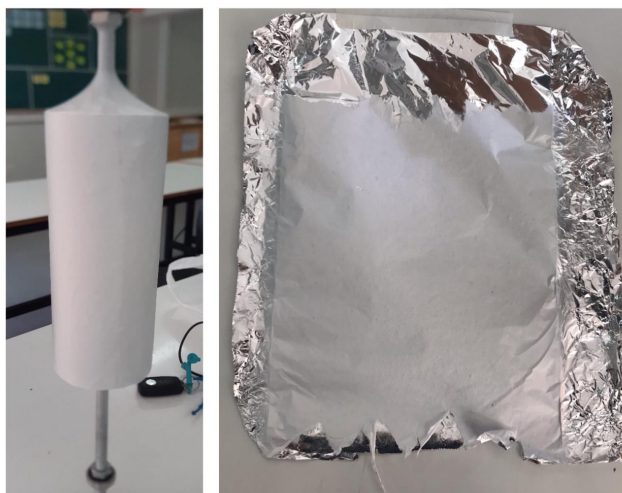
Figura 4.12 – Nanofibras obtidas pela técnica de SBS.
