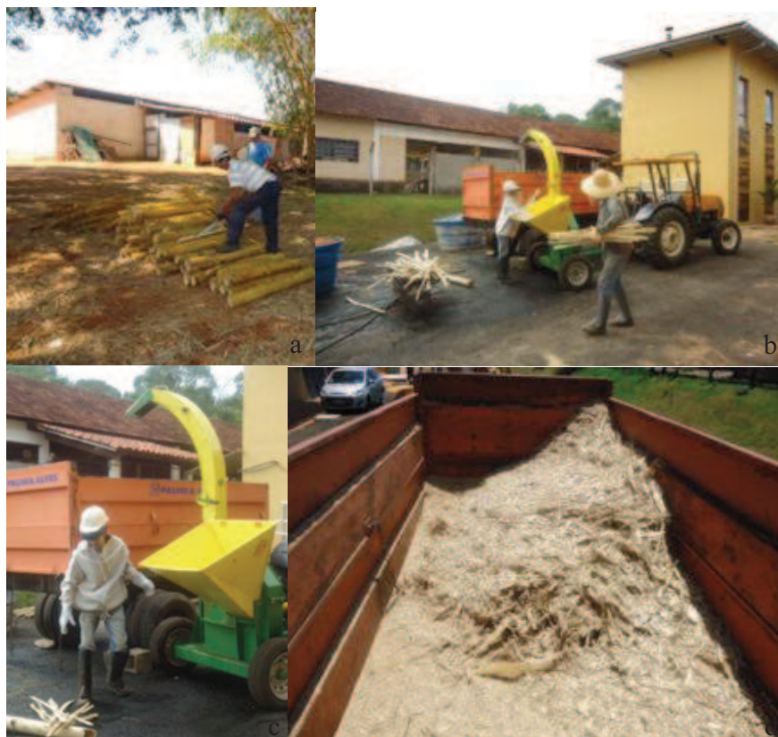
Figura 9 I Etapa do processamento das partículas de bambu: corte (a); “esmagamento” para facilitar o processo de transformação em partículas “sliver” (b, c); bambu triturado (d)
