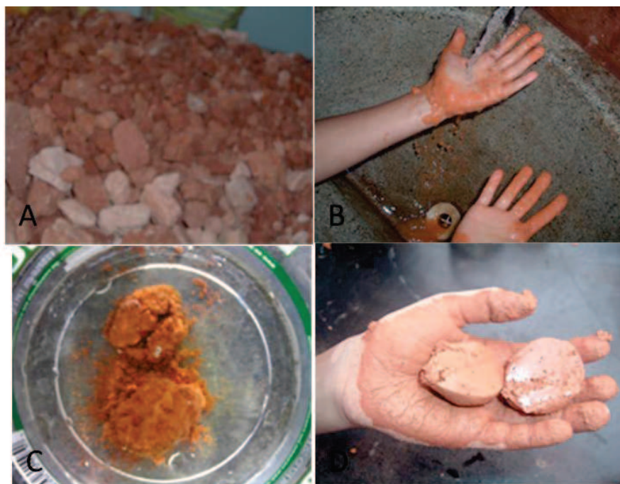
Figura 1 Testes de identificação visual e tátil. A-Cor. B- Sujar as mãos. C-Desagregação do solo submerso. D-Brilho
