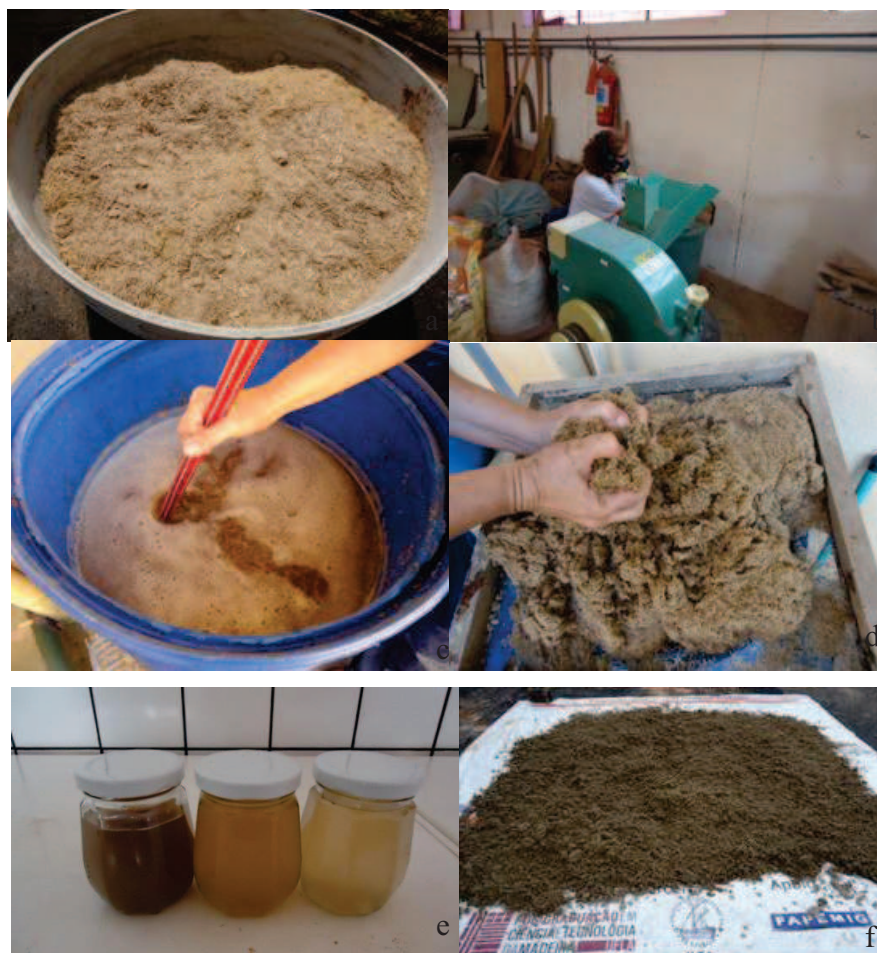
Figura 10 Processamento do bagaço de cana: material natural (a); passagem no moinho (b); lavagem (c, d); amostras de água após lavagens (e); secagem (f)
