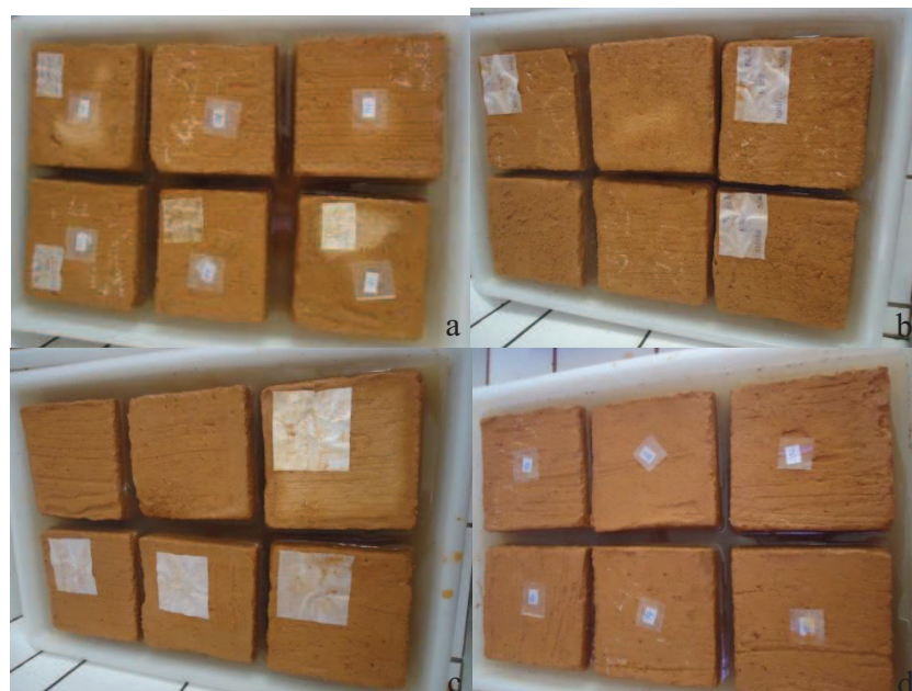
Figura 5 Imagens das amostras de adobes com “baba de cupim sintética” e bagaço de cana T5C e T6C (a, b) e bambu T7B e T8B (c, d) com 2% de partículas
