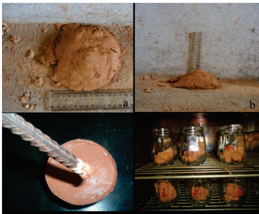
Figura 2 Teste da bola (a, b) e “Prueba de Vicat” com umidade determinada na estufa a 103 \pm 2^{\circ}\text{C} (c, d)
