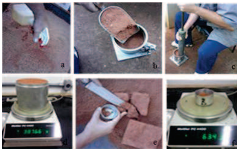
Figura 4 Etapas do ensaio Proctor Normal para determinar a umidade correspondente à massa específica aparente seca máxima: umedecimento do solo (a); colocação no cilindro (b); compactação em três camadas (c); pesagem (d); retirada de amostra (e); determinação da umidade (f)
