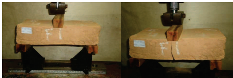
Figura 6 Início e finalização do ensaio de flexão na ETAPA I
