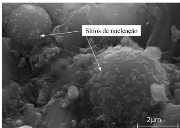
Figura 2.9 - Microscopia eletrônica de varredura de sítios de nucleação na superfície da cinza volante em pastas contendo 20% de cinza volante, após 7 dias de cura.
