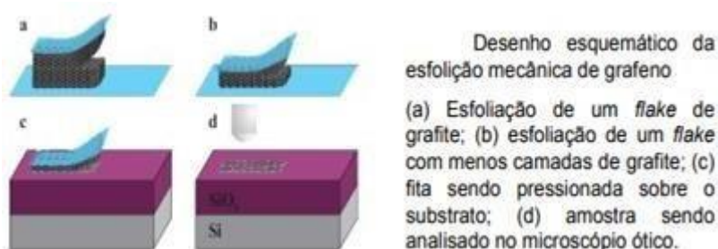
Figura 8 - Etapas da esfoliação mecânica do grafeno.
