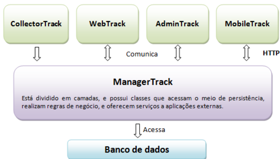
Figura 4.1: Arquitetura de comunicação entre os módulos do sistema.
