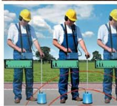
Uso do Geofone possibilita a identificação de vazamentos
