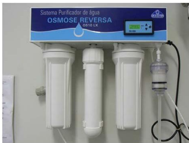
Figura 14 – Aparelho de destilação por osmose reversa.
