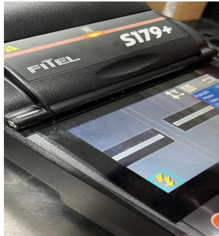
Figura 3.2 - Cavity Fabry-Perot na Máquina de emendas Fitel S179+.
