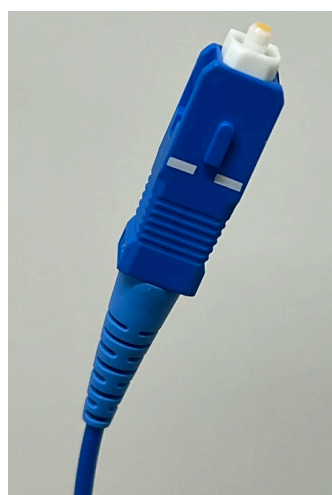
Figura 3.5 - Fibra óptica acoplada em um conector com filme fino de PSSH aplicado na extremidade.
