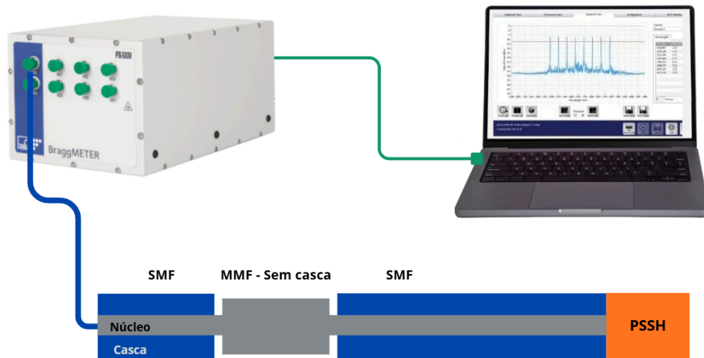
Figura 3.9 - Diagrama da hibridização do sensor MMI com FPI com filme fino.
