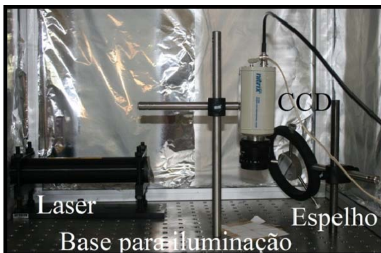
Figura 11 Arranjo experimental utilizado na avaliação de sêmen Fonte: Adaptado de Carvalho et al. (2009)
