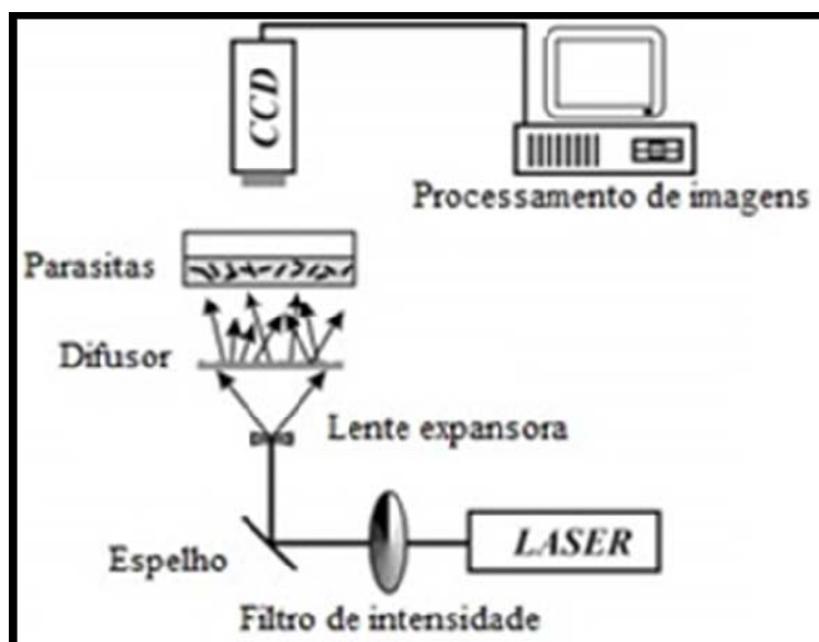
Figura 10 Arranjo experimental utilizado por Pomarico Fonte: Pomarico et al.(2004)
