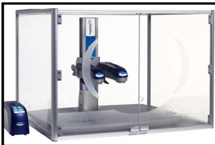
Figura 12 Equipamento para uso do biospeckle em secagem de tinta de forma comercial
