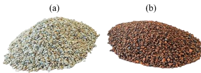
Figura 2- Zeólitas (a) e lodo de ETA (b) na condição de 2 mm de granulometria utilizados na presente pesquisa.
