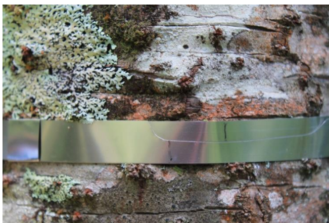
Figura 5- Cinta dendrométrica de aço inoxidável instalada à 1,30m acima do solo nas árvores de Araucaria angustifolia (Bertol) Kuntze.
