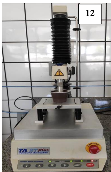
Figura 12 – Análise instrumental de textura da sobremesa láctea.
