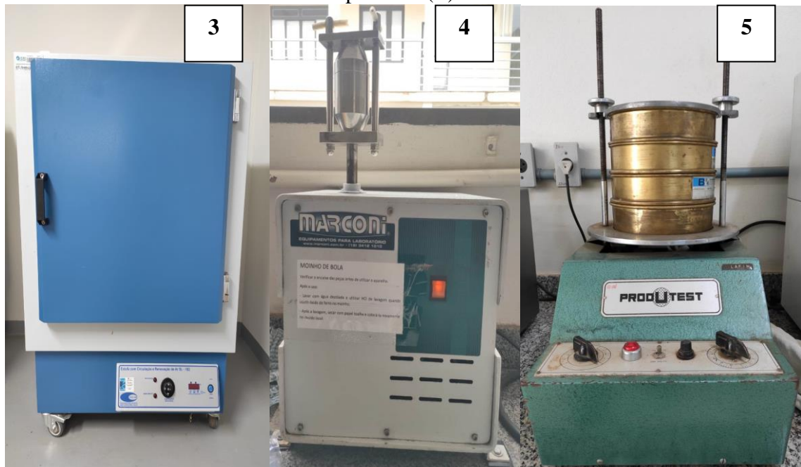
Figuras 3, 4, 5 – Estufa de circulação (C); Moinho de bolas (D); Agitador magnético de peneiras (E).
