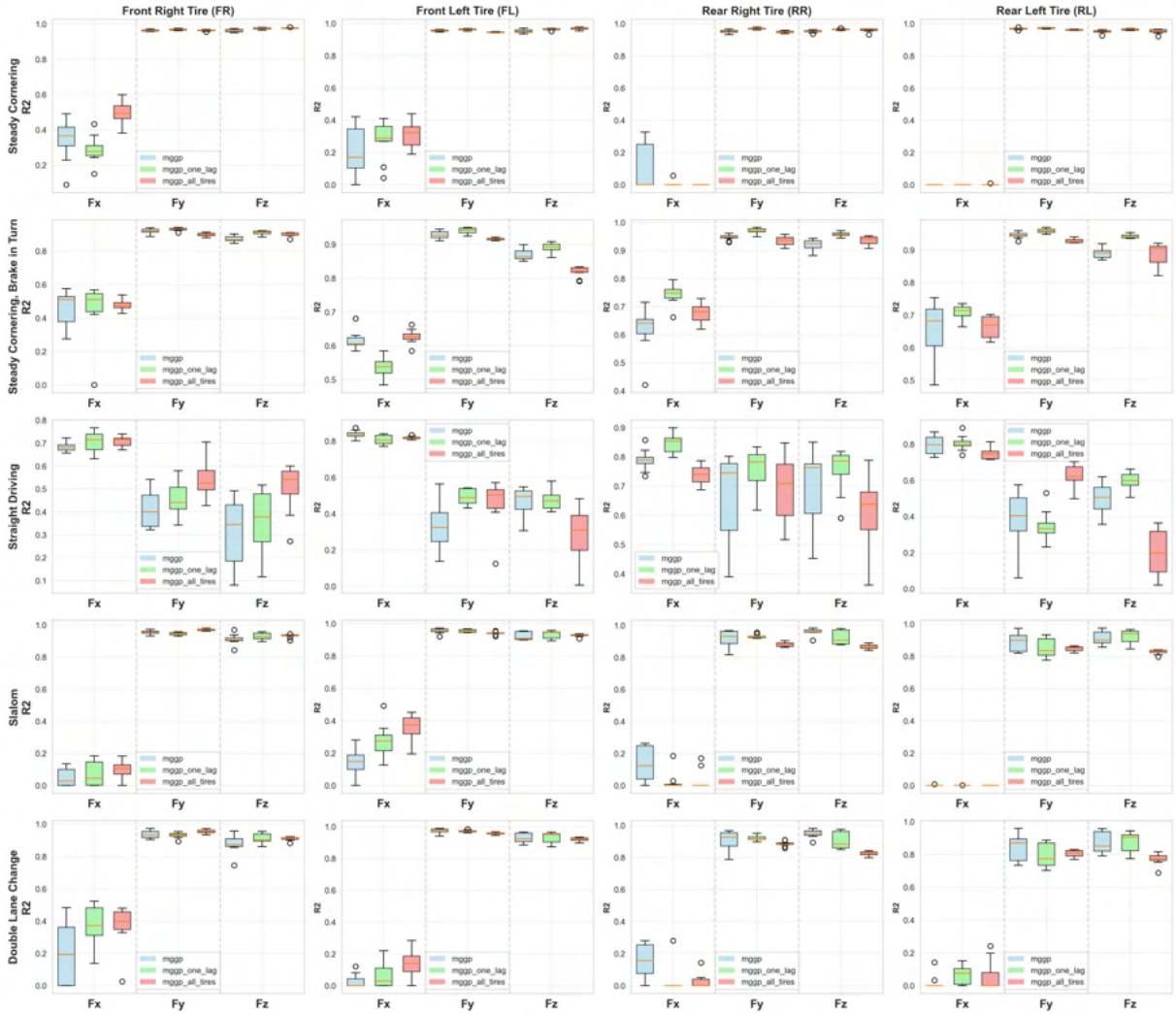
Figura 4.13 – Comparativo da Métrica R^2 - Modelos NARX/FIR c/ Multi Atrasos, c/ um Atraso, e Modelos Para Todos os Pneus
