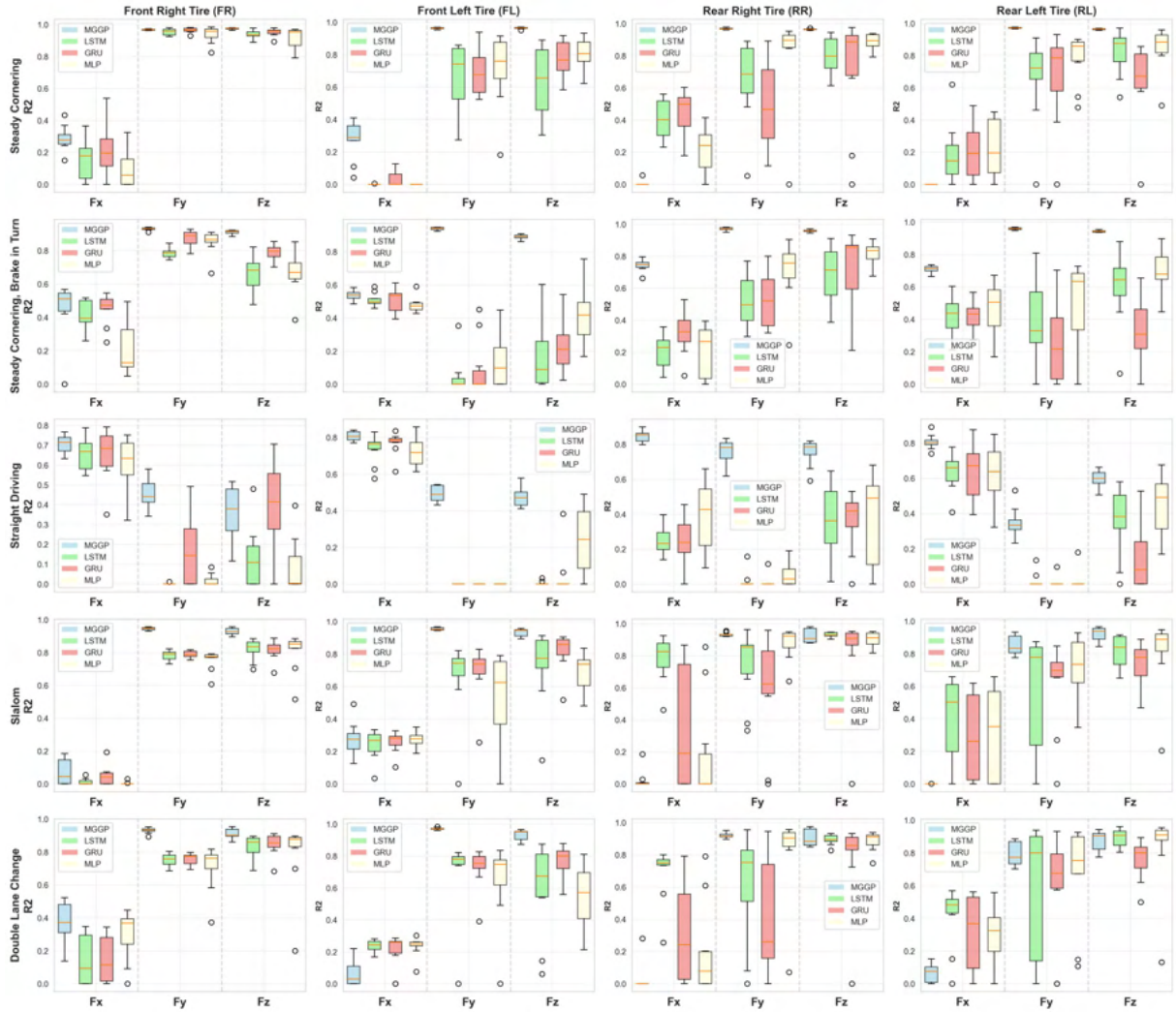
Figura 4.17 – Comparativo da métrica R^2 - Modelos via MGGP, LSTM, GRU e MLP Treinados com Um Atraso
