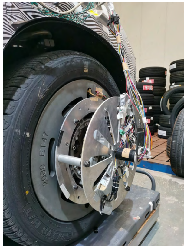
Figura 3.3 – Transdutor de Força da Roda Modelo 12.8-50
