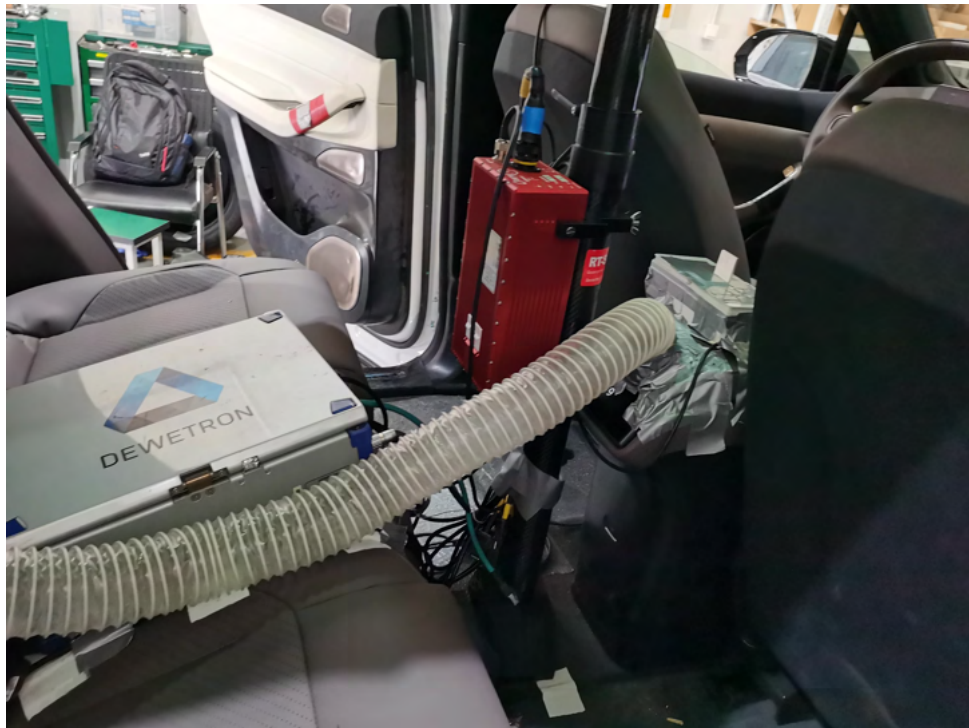
Figura 3.2 – Sistema de Aquisição DEWE2-A4
