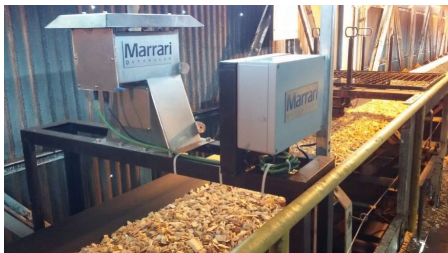
Figura 4.4 – Sistema de medição em esteira transportadora fornecido pela empresa brasileira Marrari
