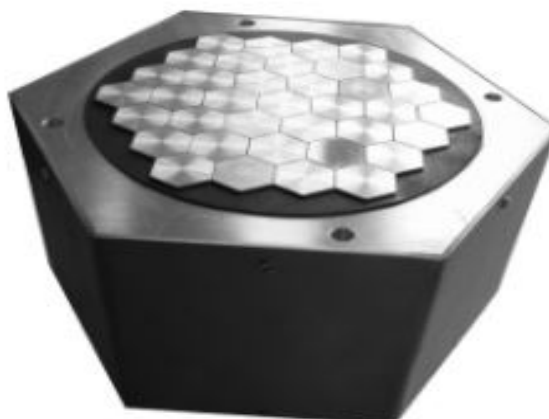
Figura 2.5 – Matriz de sensores piezoelétricos adaptados no cabeçote de distribuição.
