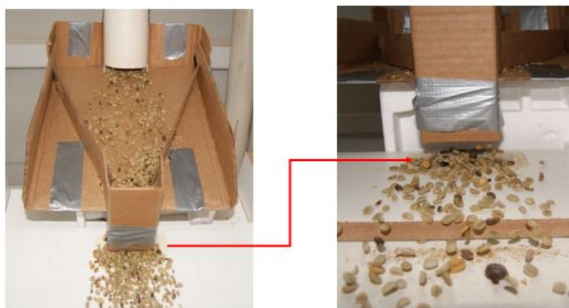
Figura 3.8 – Fluxo dos grãos sobre o sensor piezoelétrico.
