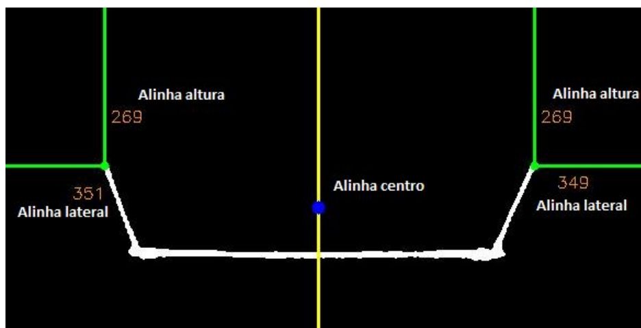
Figura 3.31 – Imagem da linha de laser sobre a esteira apresentada na tela para alinhamento da câmera
