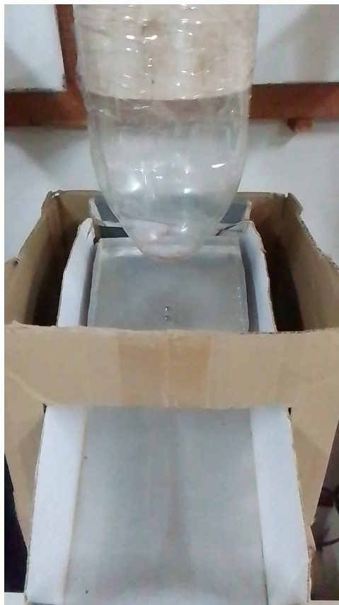
Figura 3.20 – Estrutura da célula de carga adaptada para medição de grãos de café em fluxo contínuo.
