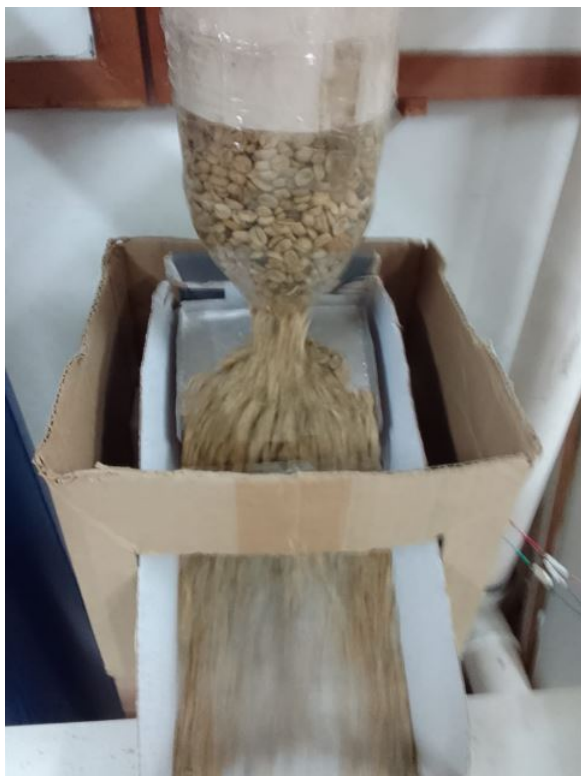
Figura 3.21 – Fluxo contínuo de grãos de café sobre a célula de carga.
