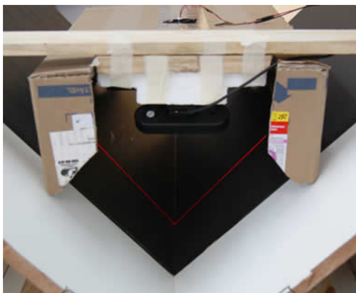
Figura 3.4 – Projeção da linha de laser na estrutura vazia.
