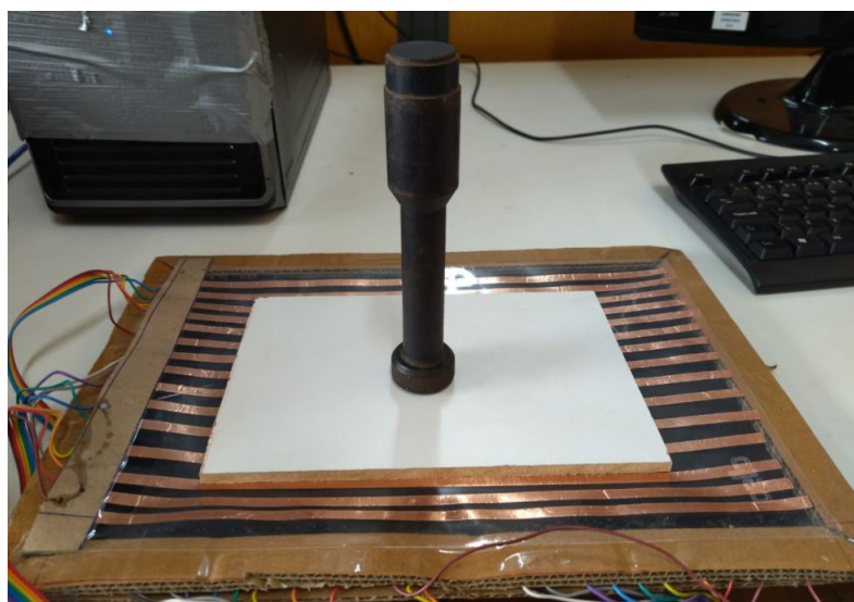
Figura 3.10 – Montagem experimental do sensor Velostat.
