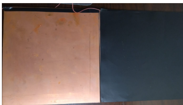
Figura 3.13 – Estrutura de fenolite - Velostat.
