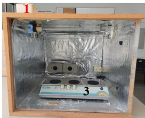
Figura 9 - Reator fotocatalítico utilizado para as reações na presença de radiação UV.
