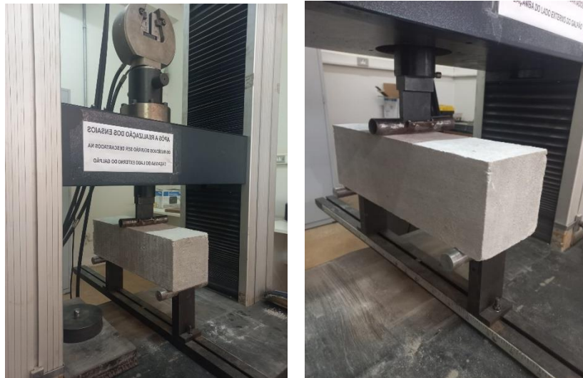
Figura 17 – Ensaio de resistência à tração na flexão em três pontos do concreto.
