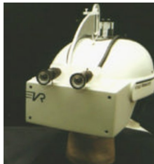
Figura 2.11: Modelo de dispositivo do sistema de visão direta por vídeo (AZUMA, 1997)
