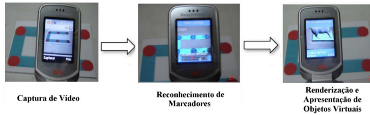
Figura 2.18: Fluxo do Processamento da Realidade Aumentada em Dispositivo Móvel
