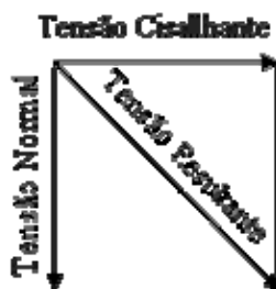
FIGURA 1 Esquema da distribuição de tensão no ensaio de cisalhamento direto.
