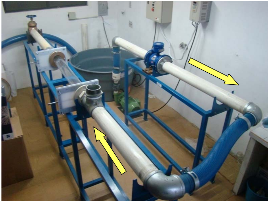
FIGURA 1 Vista geral do aparato hidráulico, baseado no respirômetro de Brett (1964).
