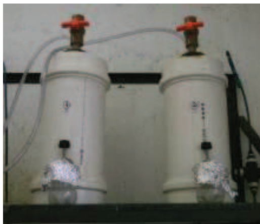
Figura 7 Gasômetros para o monitoramento do biogás
