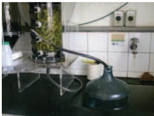
Figura 11 Efluente gerado pelo FBS sendo descartado em galão de 20 litros para o monitoramento diário da vazão do sistema
