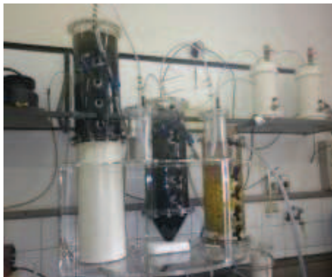
Figura 12 Sistema de tratamento em escala laboratorial compreendendo associação em série dos reatores UASB com o FBS instalado no LAADEG
