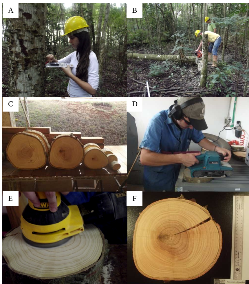
Figura 4 Obtenção dos discos para análise completa de tronco. A - Seleção e marcação das árvores-amostra; B - Coleta dos discos; C - Secagem ao ar livre; D - Polimento com lixadeira de cinta manual; E - Polimento com lixadeira orbital manual; F - Disco de árvore-amostra pronto para observação, contagem e medição dos anéis de crescimento
