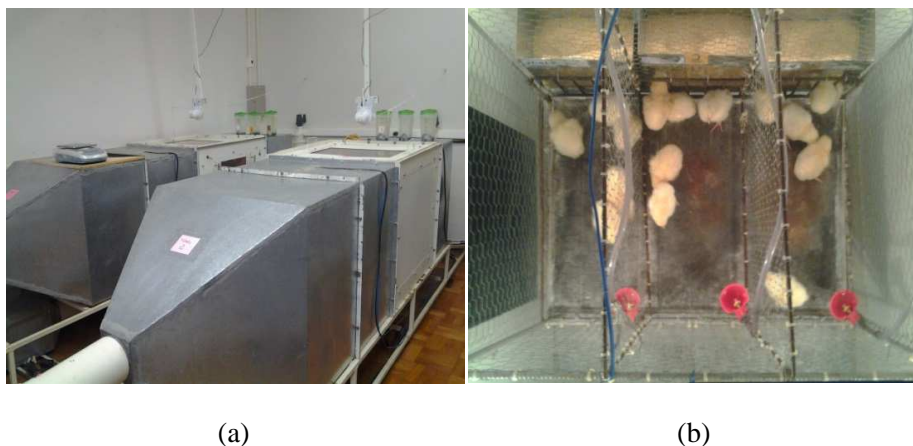
FIGURA 1 - a) Túneis de vento climatizado. b) Vista superior das gaiolas para alojamento dos frangos de corte no interior dos túneis de vento climatizados. a) Conditioned wind tunnel. b) Superior view of the cages for housing broilers in the interior of the conditioned wind tunnels.
