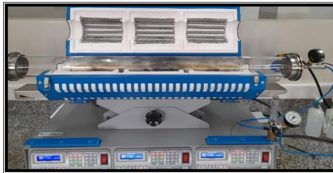
Figura 5 – Síntese de biocarvões no forno túnel.
