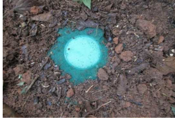
Figura 21 - Recipiente colocado na terra e coberto pela tela.
