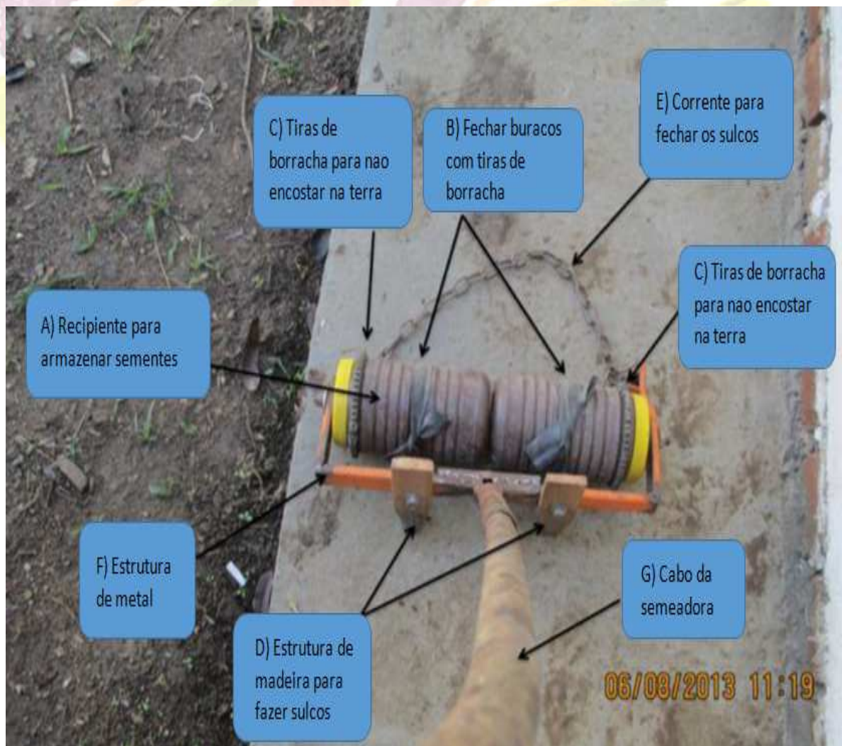
Figura 15 - Partes da plantadeira
