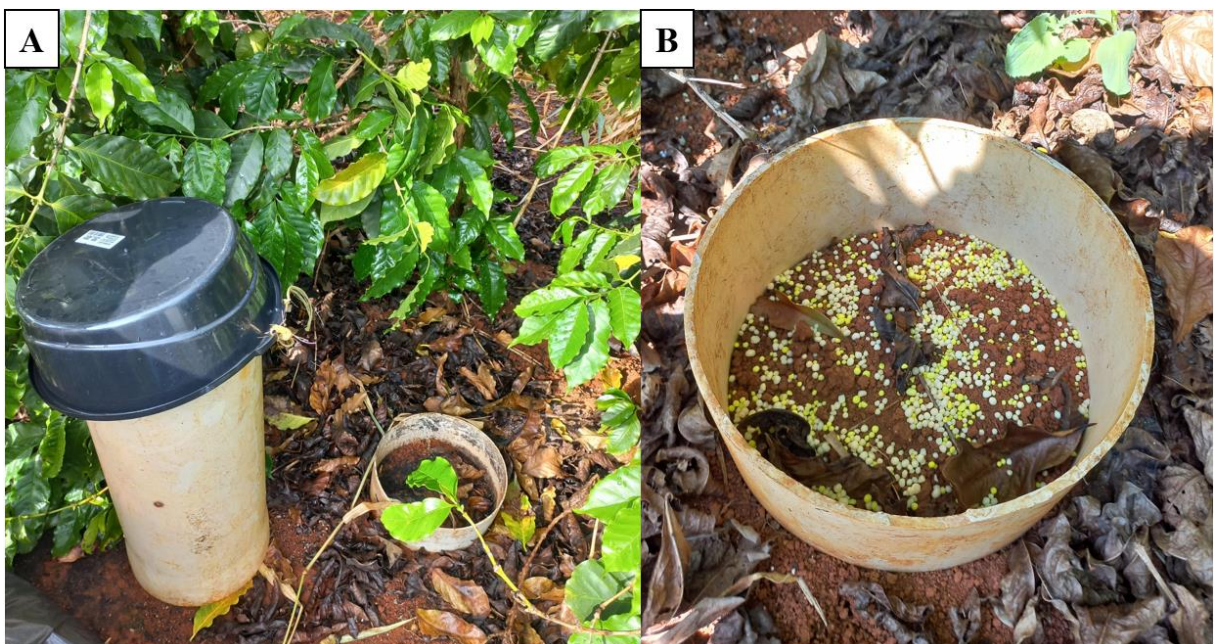
Figura 14. Coletores semiabertos e bases instalados no campo para coleta do nitrogênio volatilizado (A) e detalhe da base após a adubação (B).
