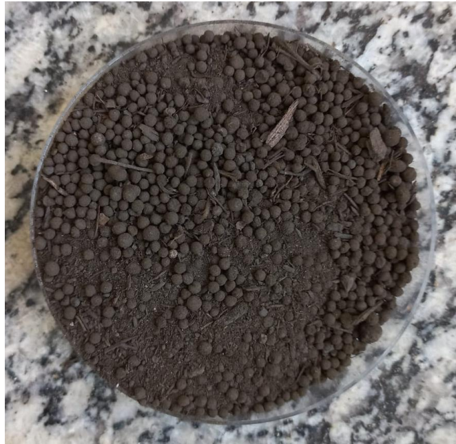
Figura 6. Aspecto físico e granulométrico do fertilizante organomineral.
