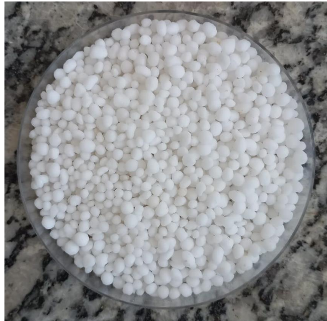
Figura 5. Aspecto físico e granulométrico da ureia convencional granulada.
