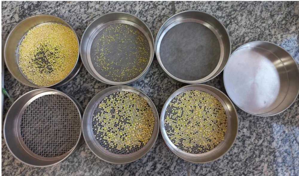
Figura 3. Peneiras e quantidade retida da amostra, por peneira, para cálculo do índice de dispersão de partículas em fertilizantes nitrogenados.
