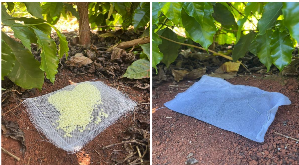
Figura 3. Local de inserção dos sacos de Nylon com os fertilizantes para realização do teste de liberação em campo (projecção da copa).
