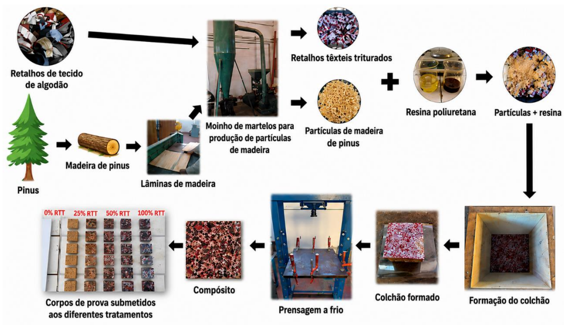
Figura 1 - Representação esquemática das etapas do processo de produção dos painéis, incluindo a obtenção das matérias-primas, processamento das partículas e formação dos painéis
