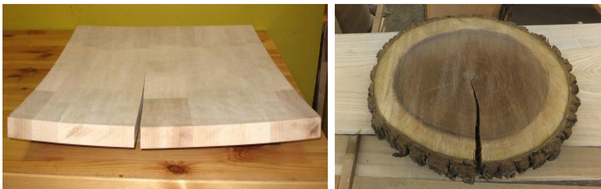
Figura 5 - Defeitos de secagem da madeira. Empenamento à esquerda e rachadura à direita.
