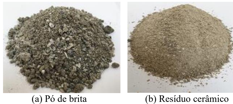
Figura 2 - Agregados utilizados nas dosagens das argamassas.
