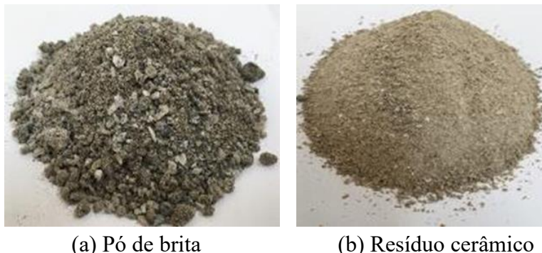
Figura 2 - Agregados utilizados nas dosagens das argamassas.
