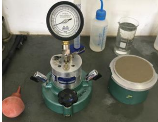
Figura 3 - Equipamento para determinação do ar incorporado em argamassas.
