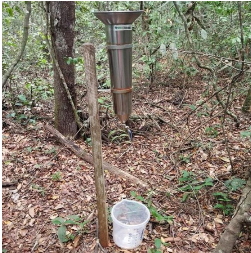
Figura 2.2 – Pluviômetro instalado nos pontos de monitoramento no interior da FESM.
