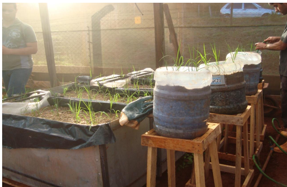
Figura 2 Detalhe do filtro inserido nos sistemas wetlands ainda em fase inicial de operação
