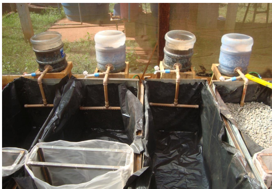
Figura 2 Sistemas wetlands sendo preenchidos e detalhe do filtro inserido nos sistemas horizontais
