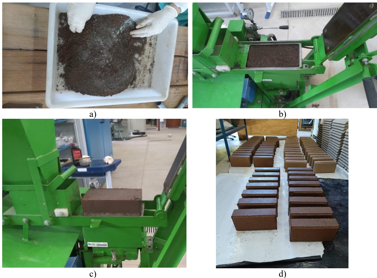
Figura 1 – Processo de produção dos tijolos ecológicos.
