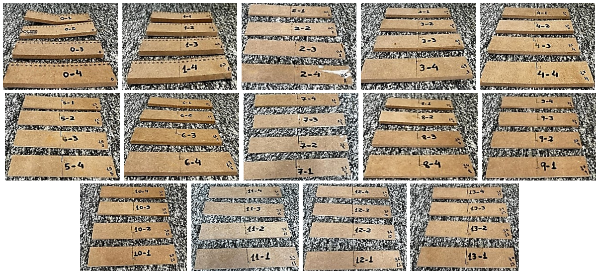
Figura 24 - Corpos de prova submetidos ao teste de flexão.
