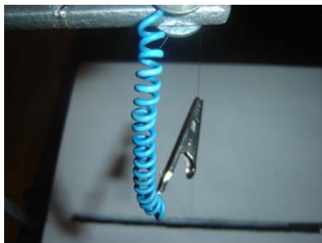
Figura 8 Detalhe da parte superior do aparelho. O conector jacaré isola parte da resistência e aumenta a potência da máquina ao deslizar para baixo
