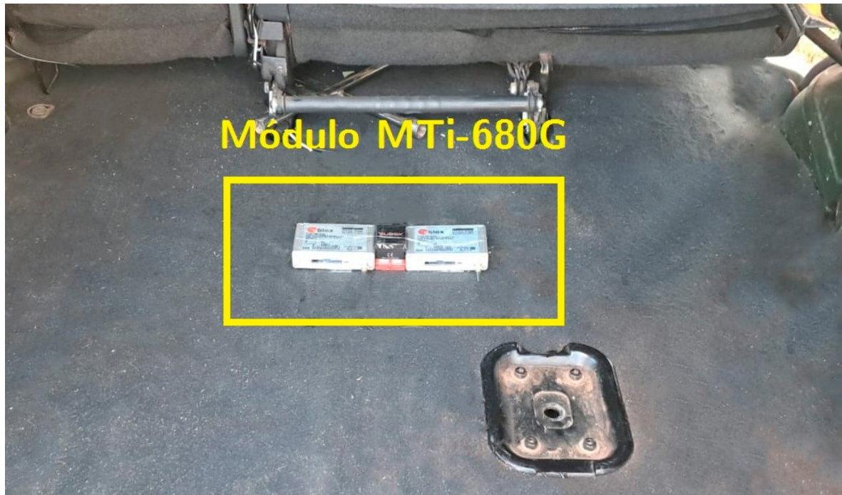
Figura 5.14 – Módulo MTi-680G instalado próximo ao centro do eixo das rodas traseiras do veículo.
