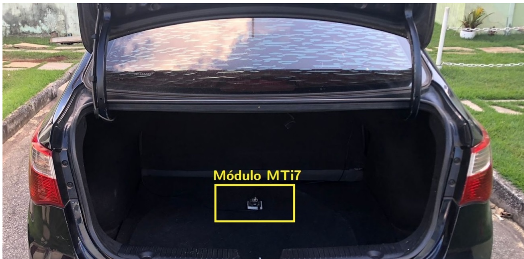
Figura 5.7 – Módulo MTi7 instalado próximo ao eixo das rodas traseiras do veículo.
