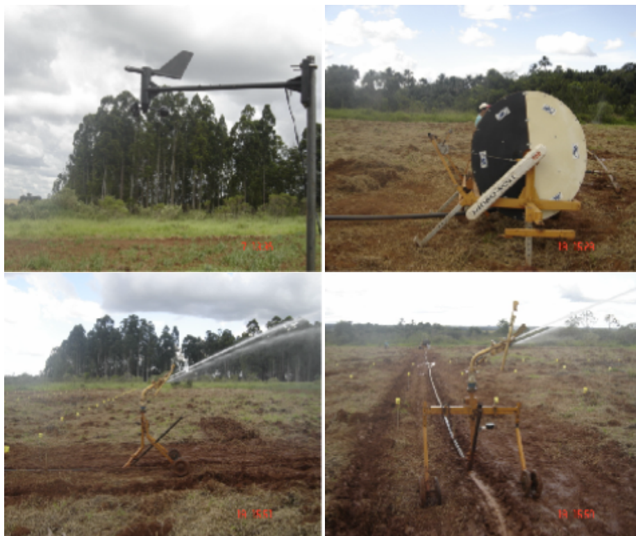
FIGURA 22 - Ensaio de distribuição de água do aspersor Plona-RL250 operando em um sistema autopropelido de irrigação.
