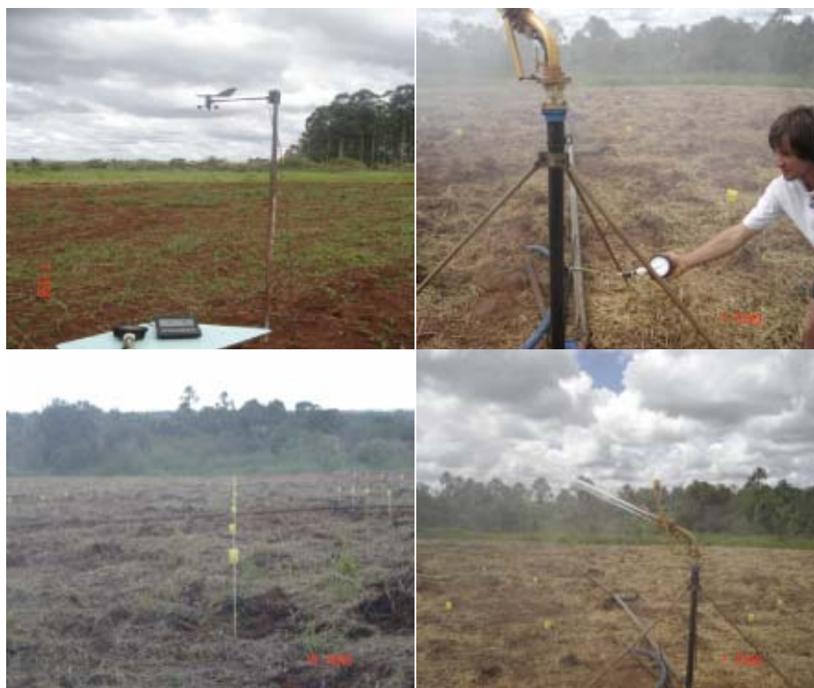
FIGURA 14 - Ensaio de distribuição de água do aspersor Plona-RL250 operando isoladamente em condições de vento.
