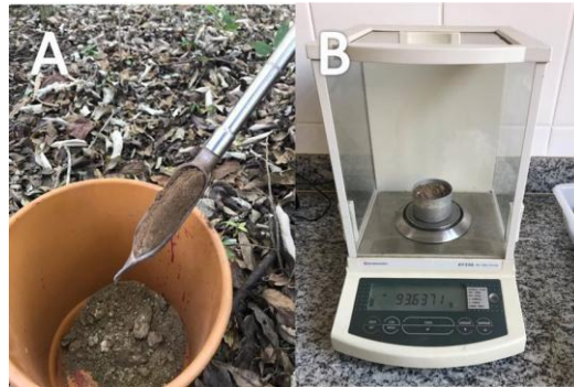
Figura 3 –A) Trado Holandês; B) Balança analítica.
