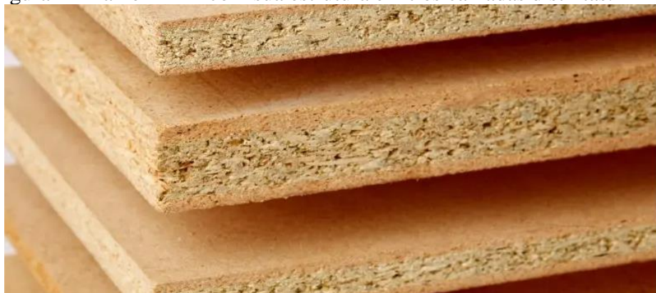
Figura 1 – Painel MDP com sua estrutura em três camadas distintas.
